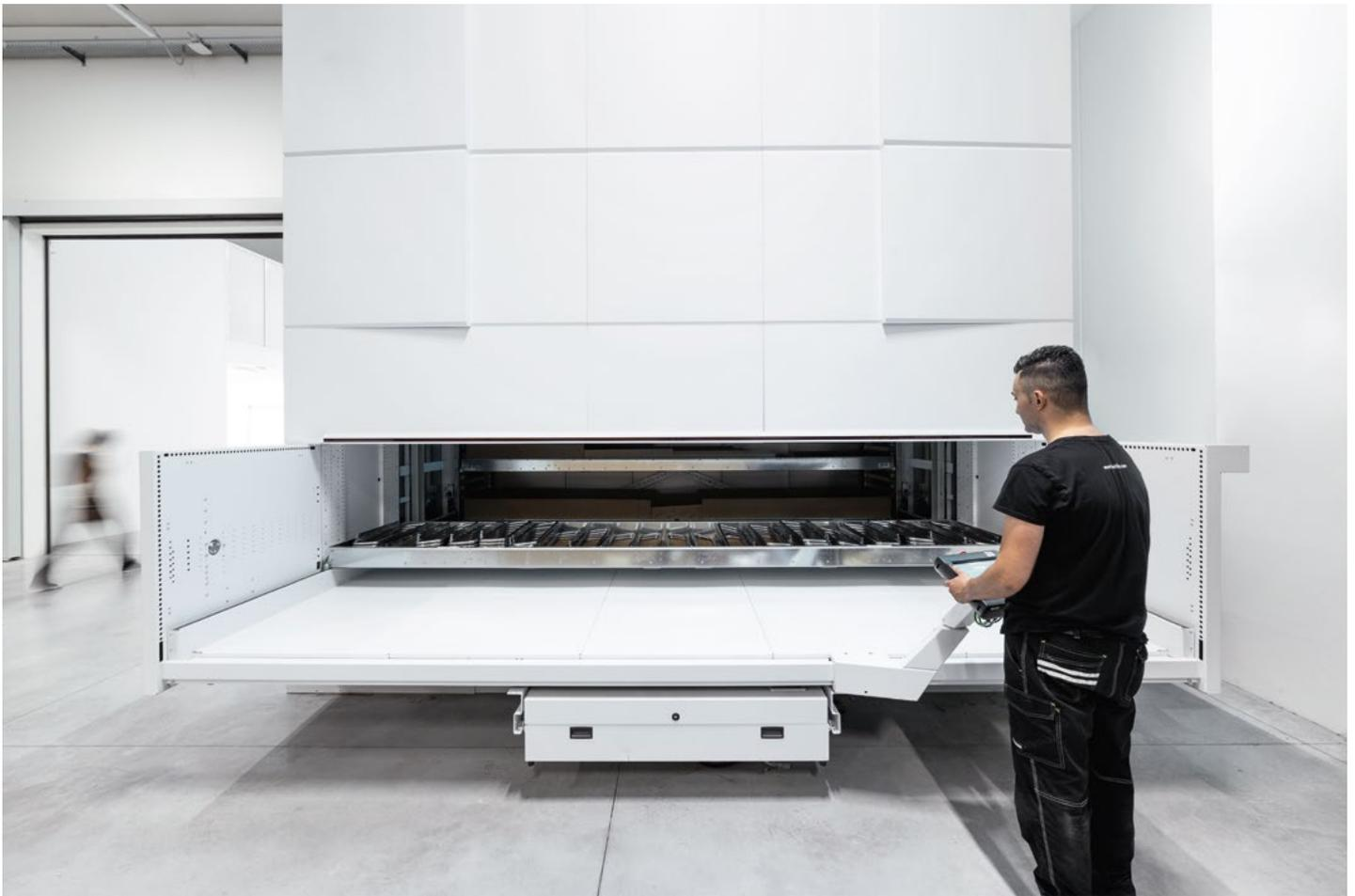
**Il magazzino automatizzato per la minuteria e la macchina per gli imballaggi su misura: due elementi importanti per la digitalizzazione aziendale. The automated warehouse for small parts and the custom packaging machine are two important assets for company digitisation.**
